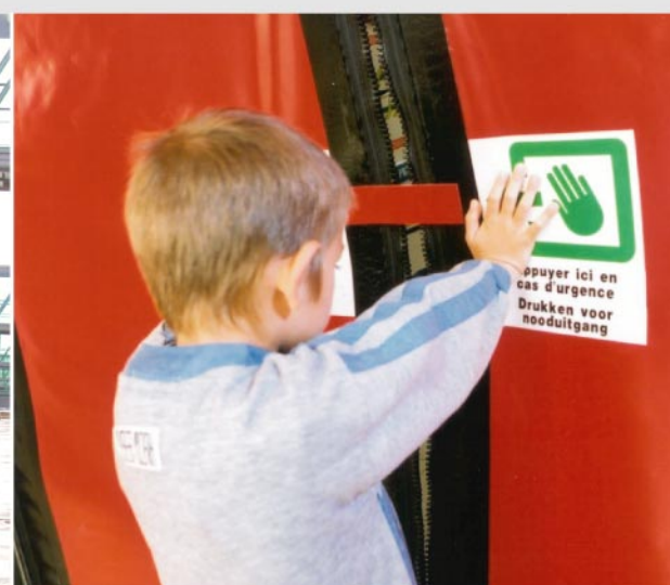
Nouzový východ vznikne ručním rozpojením "zipového" systému
